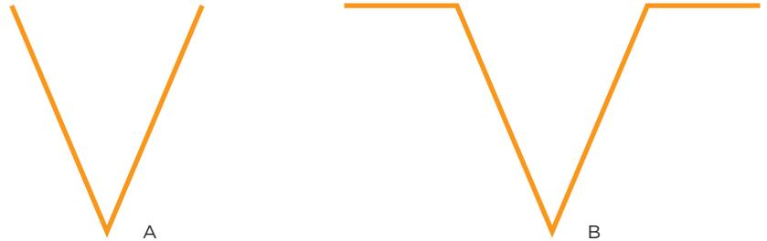
▲ **Figure 4:** CONTOUR OF JUNCTION FIRE FRONTS: A) CONSIDERED IN ALL PREVIOUS STUDIES, B) OBSERVED IN THE FIELD EXPERIMENTS.
