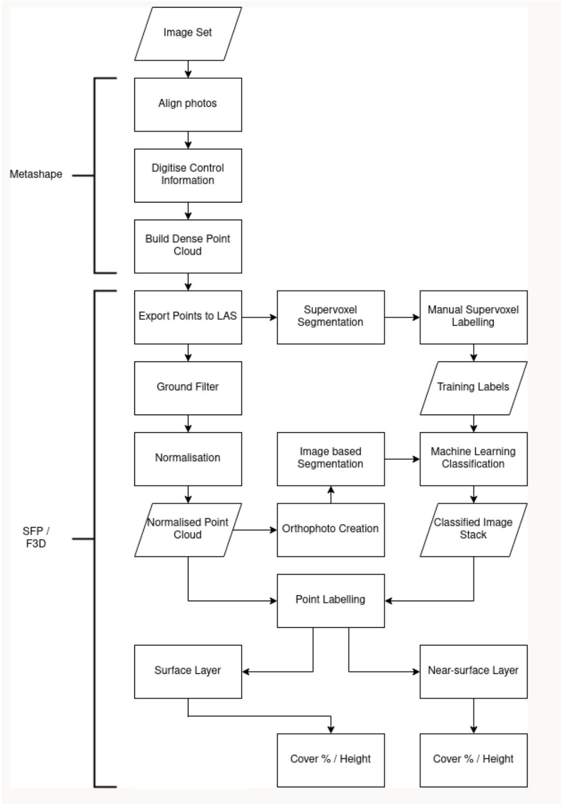
FIGURE 4. OVERVIEW OF PROCESSING STEPS FOR EXTRACTING FUEL HAZARD METRICS FOR SURFACE AND NEAR-SURFACE FUEL LAYERS.
